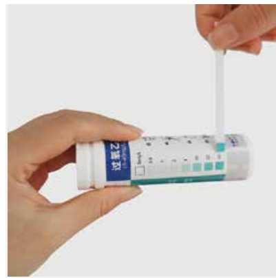
3. 经过特定的反应时间（通常不超过1分钟），将试纸反应区的颜色与试纸筒上的标准色卡进行比较，读出相应浓度。
